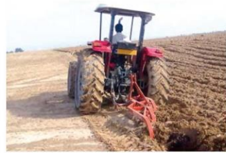
شکل ۱: شخم زدن مرسوم با گاو آهن برگردان دار در زمین غازی از پوشش گیاهی
